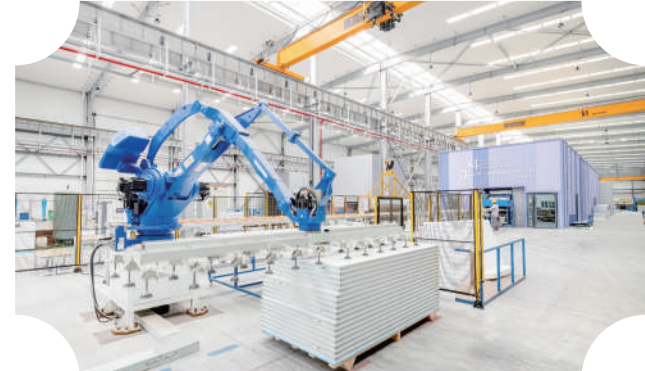
洁净板自动化生产线。
