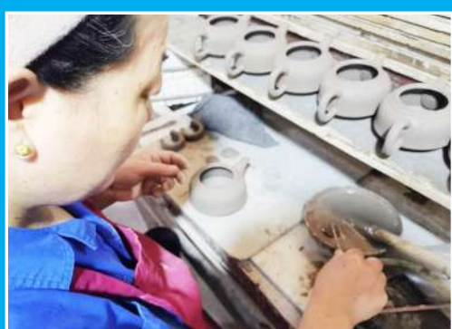
成型后的海瓷胚体经过第一次简单修整、粘结,成为完整的器型。
