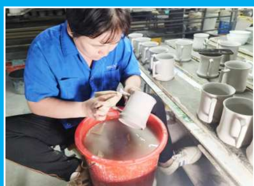
海瓷胚体经过10多个小时阴干,工人再次用海绵沾水进行清洗,清除表面的灰尘、附着的颗粒。
