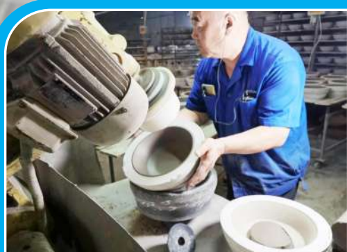
含有贝壳砂的海瓷胚浆注模成型。
